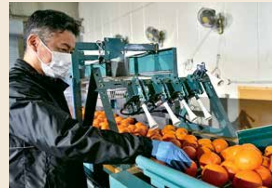
ワックス塗布機で中晩かんにワックス処理をする様子
